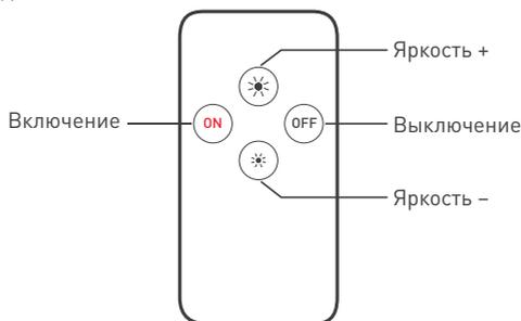
Рисунок 2. Назначение кнопок на пульте SMART-MINI-DIM-SET
