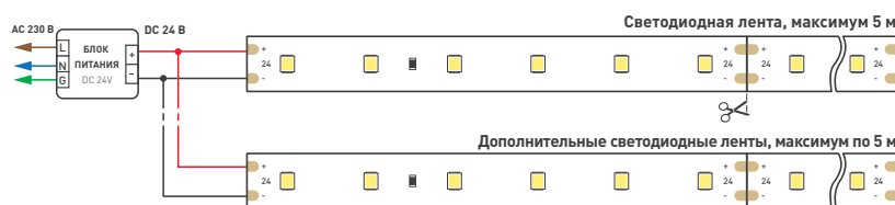
Схема 1. Подключение нескольких светодиодных лент с одной стороны
