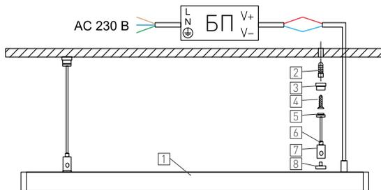
Рис. 2. Монтаж светильника
