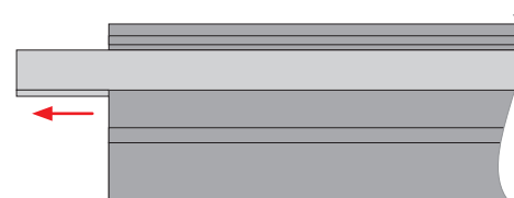
Рис. 1. Извлечение экрана ② из профиля ①, вид сверху
