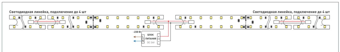
Подключение более двух светодиодных линеек с одной стороны.
