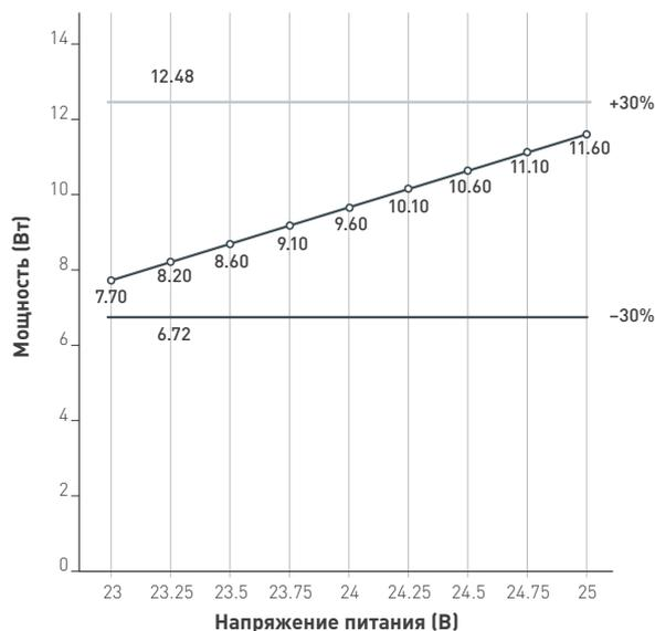
Указаны предельные границы допустимого отклонения питания линейки
