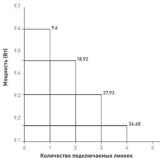
\* Мощность линейки снижается при увеличении длины подключаемого отрезка из-за падения напряжения по длине линейки
