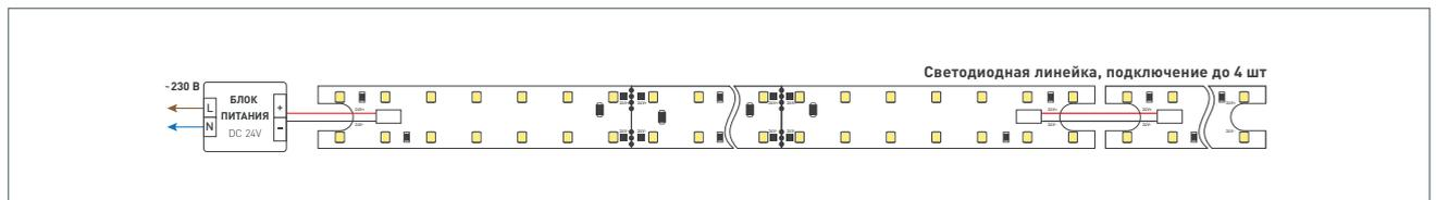
Подключение двух светодиодных линеек с одной стороны.
