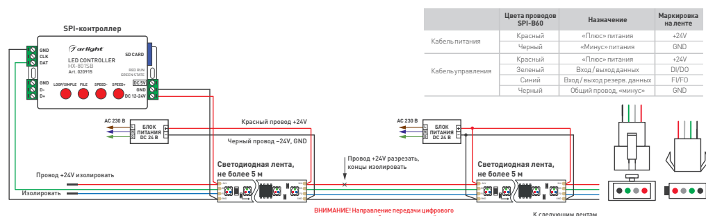
Схема 1. Подключение ленты с использованием SPI-контроллера с одним выходным портом и с использованием отдельных блоков питания.
