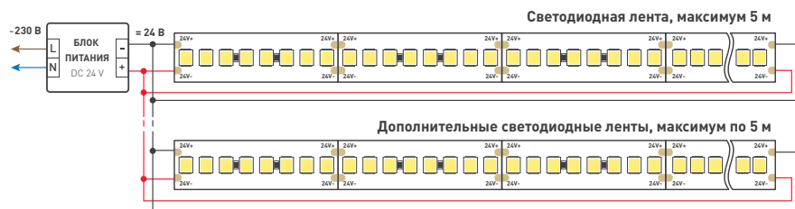
Схема 1. Подключение нескольких светодиодных лент с двух сторон. Рекомендуется использовать для обеспечения равномерного свечения ленты по всей длине
