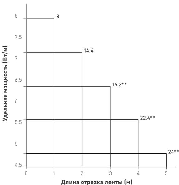
\* Удельная мощность ленты снижается при увеличении длины подключаемого отрезка из-за падения напряжения по длине ленты.
