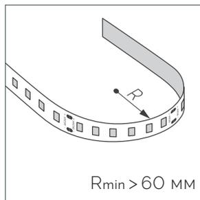
$R_{min} > 60 \text{ мм}$
