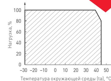
Рис. 1. Максимальная допустимая нагрузка, % от мощности источника
