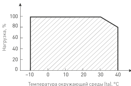
Рис. 2. Максимальная допустимая нагрузка, % от мощности источника
