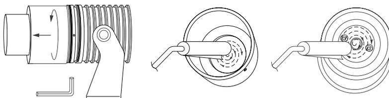
Рис. 4. Разборка и чистка светильника
