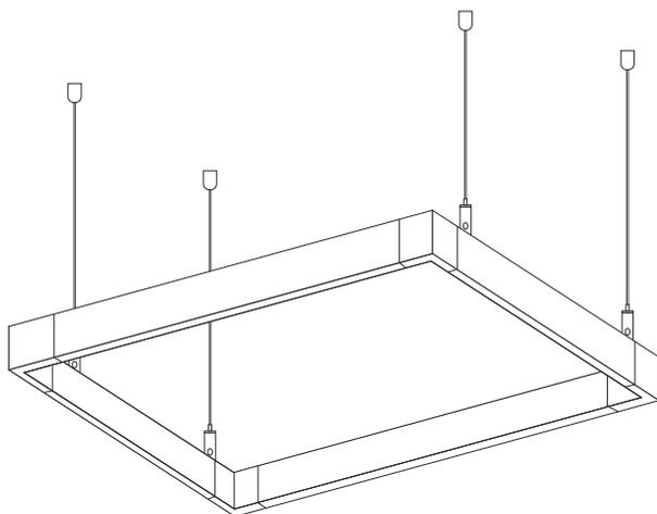
Рис. 1. Собранный светильник
