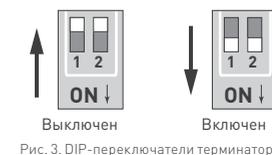
Рис. 3. DIP-переключатели терминатора
