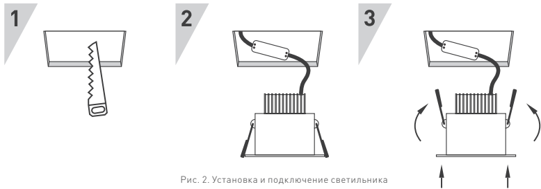
Рис. 2. Установка и подключение светильника
