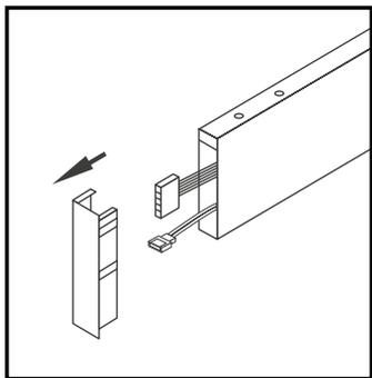
2.1. Снимите заглушку со светильника (1) с обратной стороны от кабеля питания. Извлеките коннекторы из светильника.
