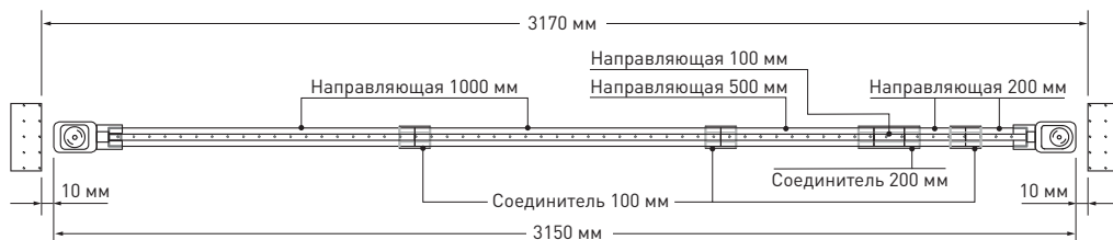
Рис. 4. Пример сборки направляющей длиной 3.15 м
