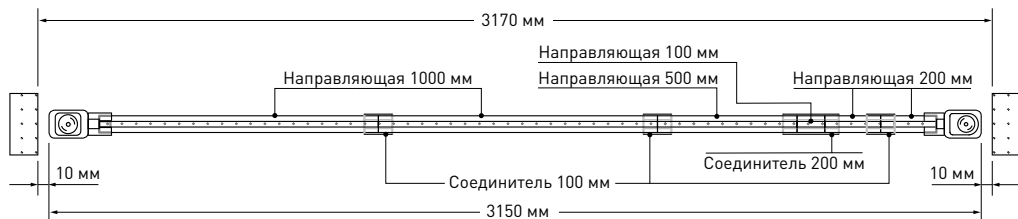
Рис. 4. Пример сборки направляющей длиной 3.15 м
