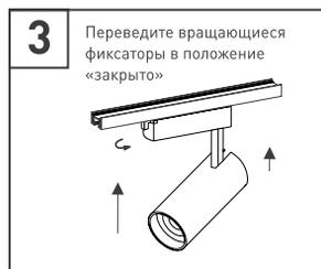
Рис. 3. Установка и подключение светильника
