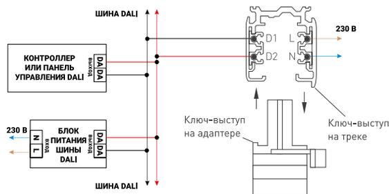
Рис. 2. Схема подключения светильников с управлением DALI
